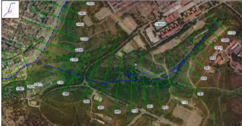
Şekil 26 Baruthane deresi üzerinde tanımlanan kesitler
