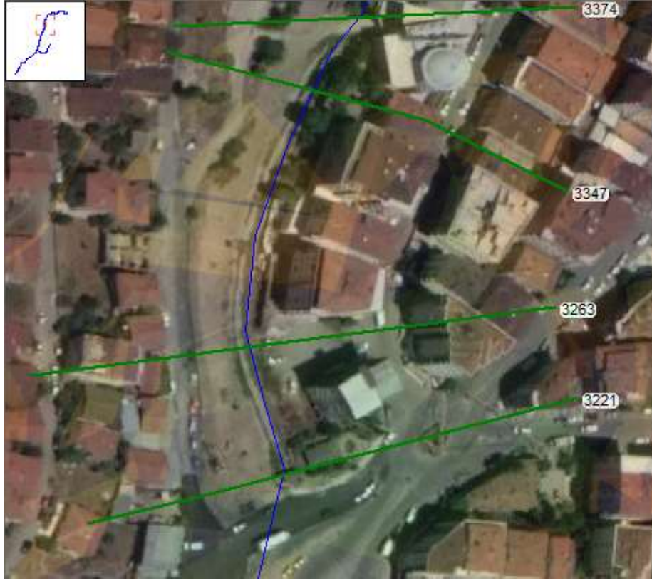
Şekil 8 Çamaşircı deresi 3347m-3263m arası tanımlanan kesitler
