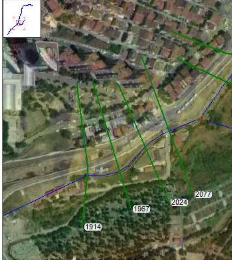
Şekil 17 Çamaşırcı deresi mansap kolu E5 e kadar tanımlanan kesitler
