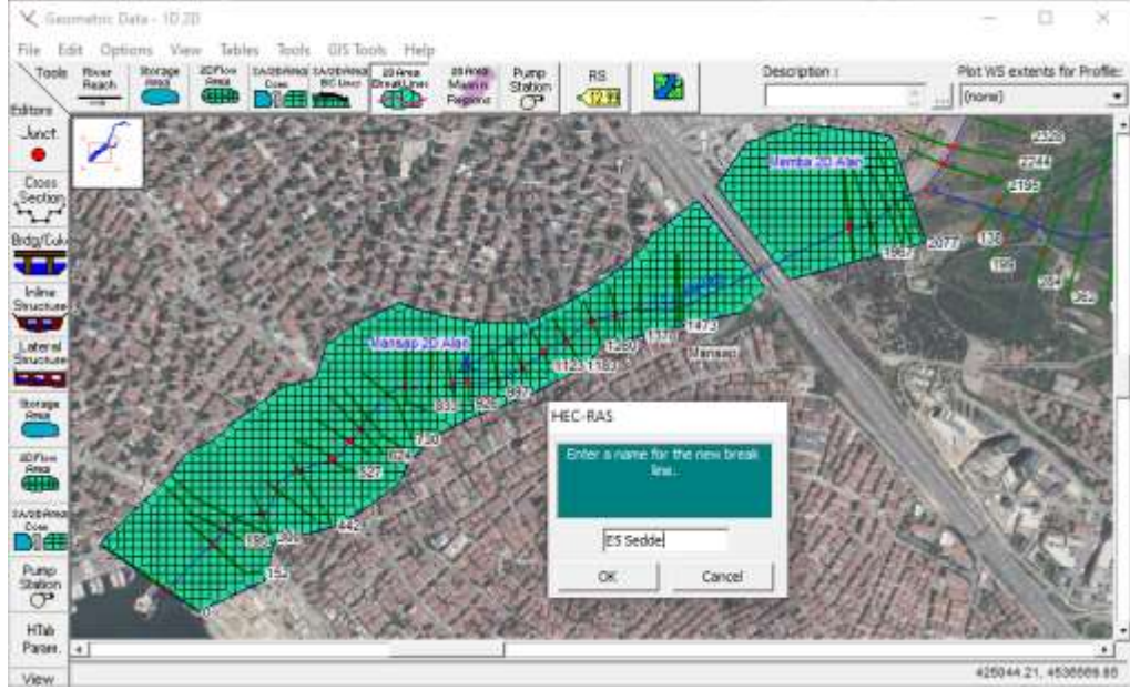
Şekil 8 2D alanlar arasında ayırma çizgisinin tanımlanması
