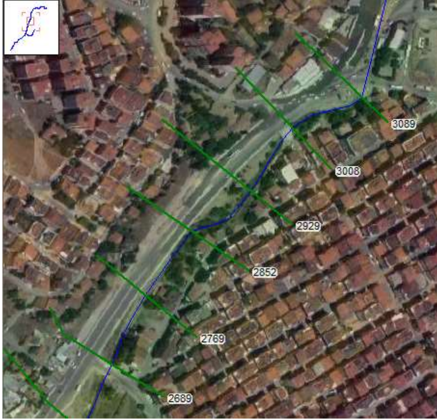
Şekil 12 Çamaşırıcı deresi 3089m-2689m arası tanımlanan kesitler
