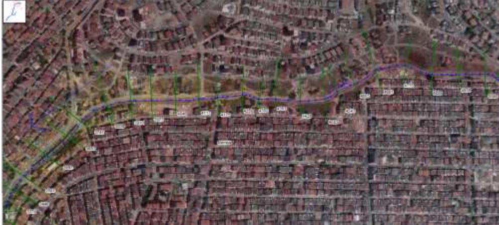
Şekil 5 Çamaşırcı deresi 5019m-3374m arası tanımlanan kesitler
