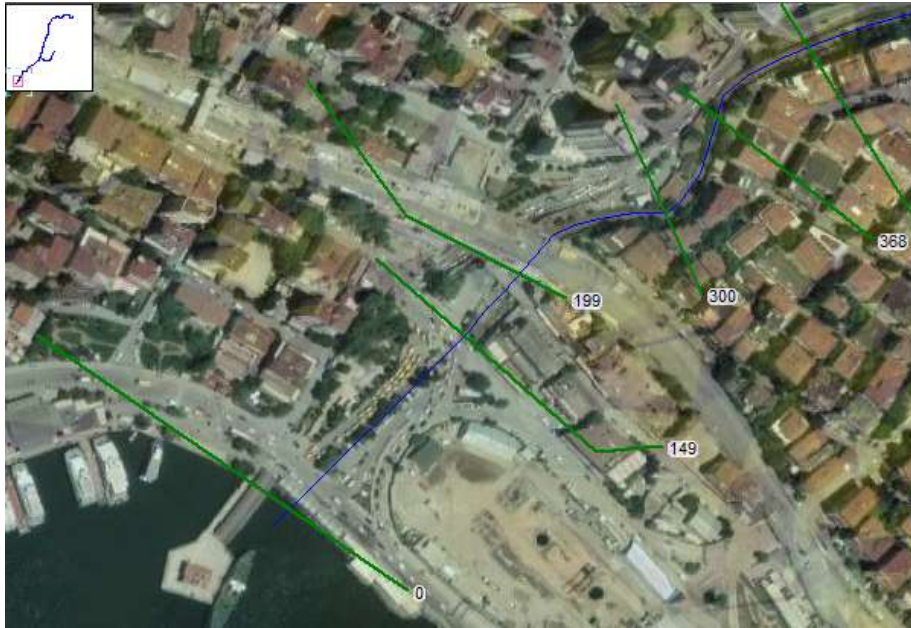
Şekil 24 Çamaşırcı deresi mansap kolu 199-0 arasında tanımlı kesitler
